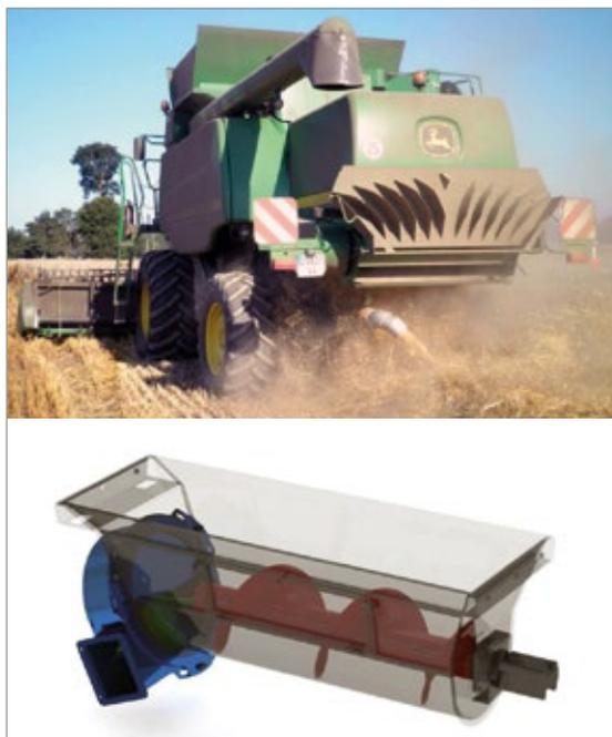
Figura 5 - Sistema a turbina Thievin con scarico sull'andana.
