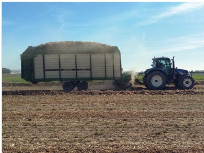
Figura 2 - Raccolta degli stocchi con carro autocaricante.
