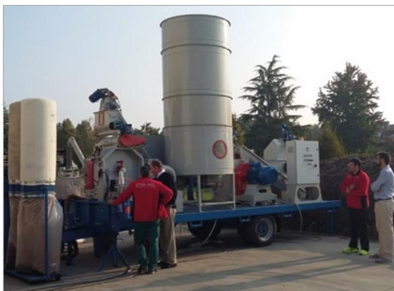
Figura 1 - Impianto mobile per la produzione di pellet sviluppato da Costruzioni Nazzareno.
