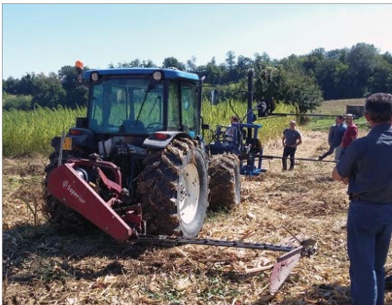
Figura 2 - Barra falciante posteriore GS Superior.
