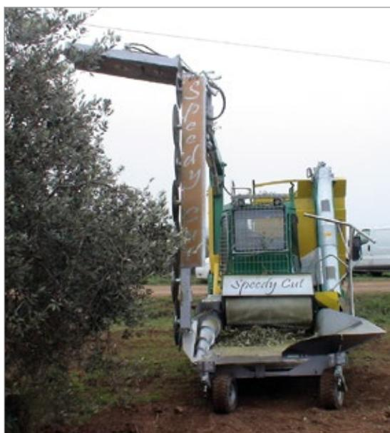
**Figura 6** - Operazione di potatura e cippatura simultanea con macchina operatrice semovente "Speedy-cut" (Fonte: <https://bit.ly/2vajjgd>).
