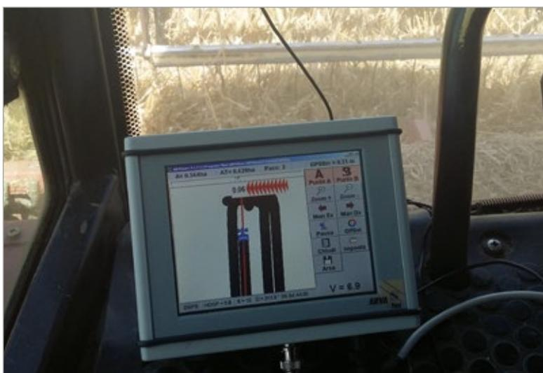
Figura 1 - Dispositivo ARVAnav 2 all'interno della cabina della mietitrebbia.
