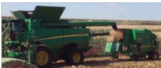
Figura 11 - Imballatrice no-stop John Deere della Hillco Technologies.
