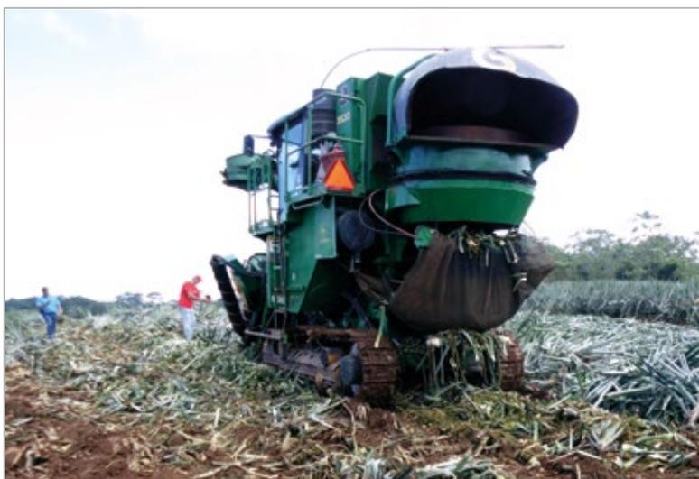
Figura 5 - Telo di plastica posizionato sotto al punto di scarico della macchina.
