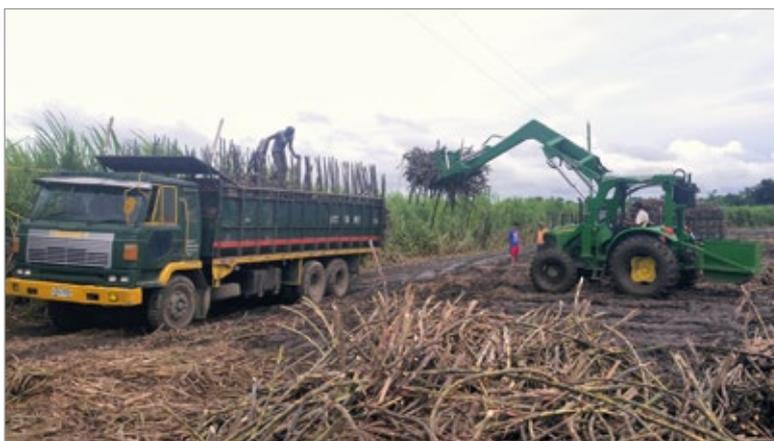
Figura 5 - Fase di caricamento meccanizzato su camion.
