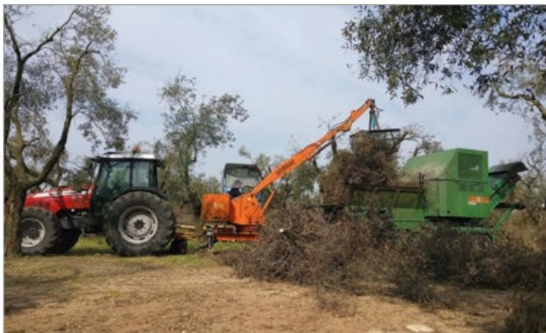
**Figura 5** - Cantiere di raccolta e cippatura delle potature di olivo con cippatrice forestale a punto fisso.
